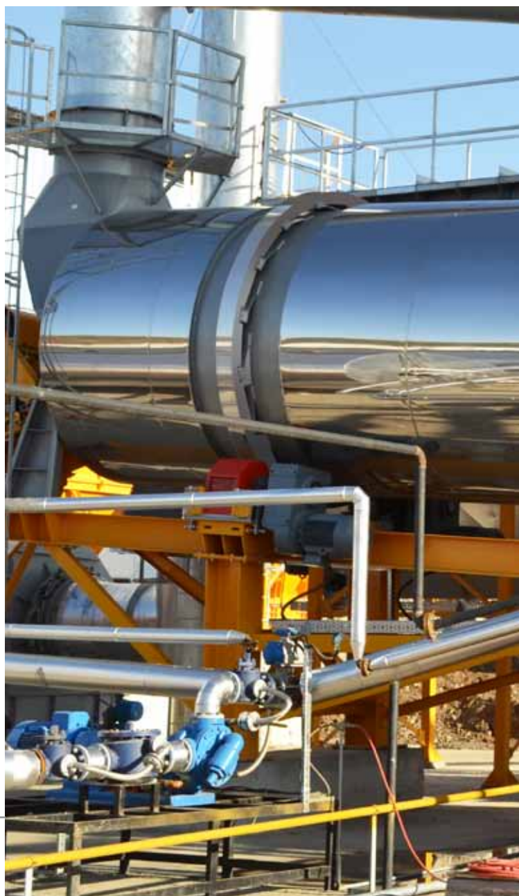
Эффективная конструкция лопастей с болтовыми креплениями для оптимальной сушки Efficient blade desing in bolted construction for optimum drying
