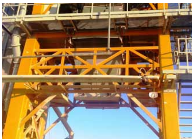
Прямая разгрузка без бункера-накопителя Direct loading, no hot mix silo
