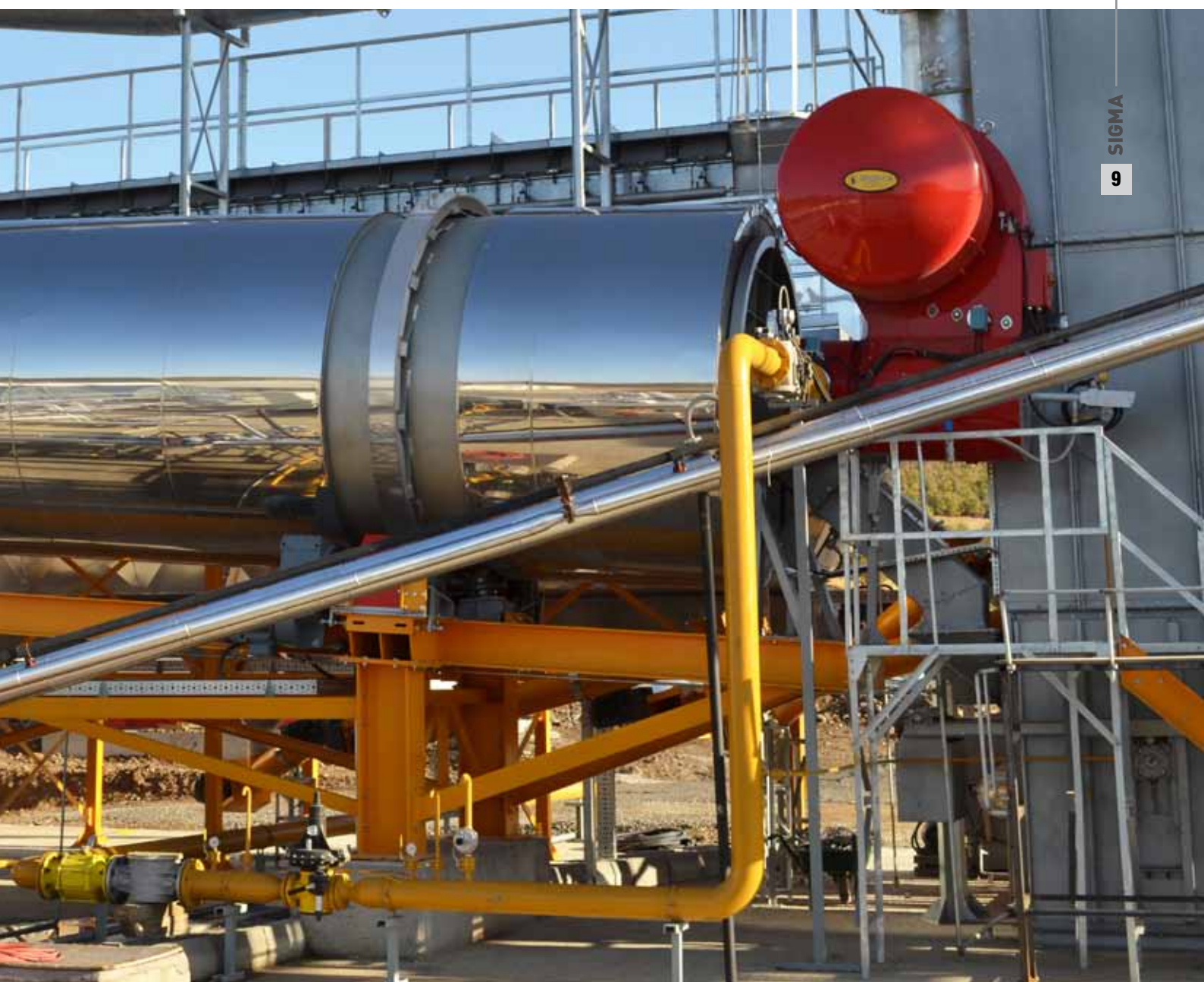
Высокоэффективная моноблочная горелка Highly efficient monobloc burner
