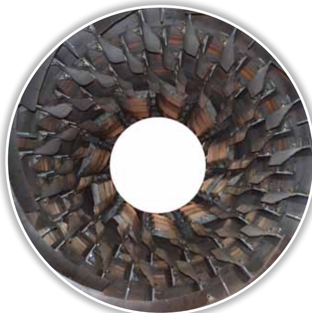
Эффективная конструкция лопастей с болтовыми креплениями для оптимальной сушки Efficient blade desing in bolted construction for optimum drying
