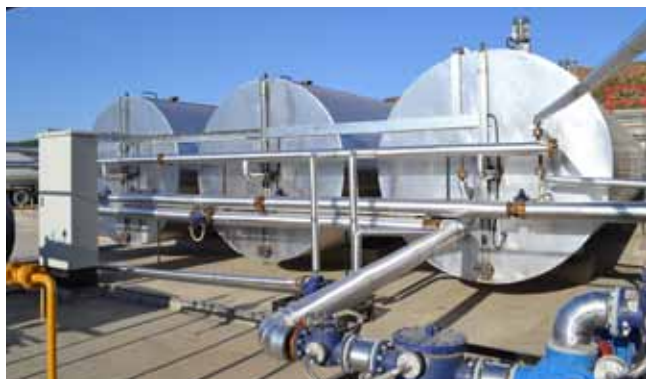
Горизонтальные битумные емкости с термомасляным обогревом Horizontal bitumen tanks, thermal oil heated
